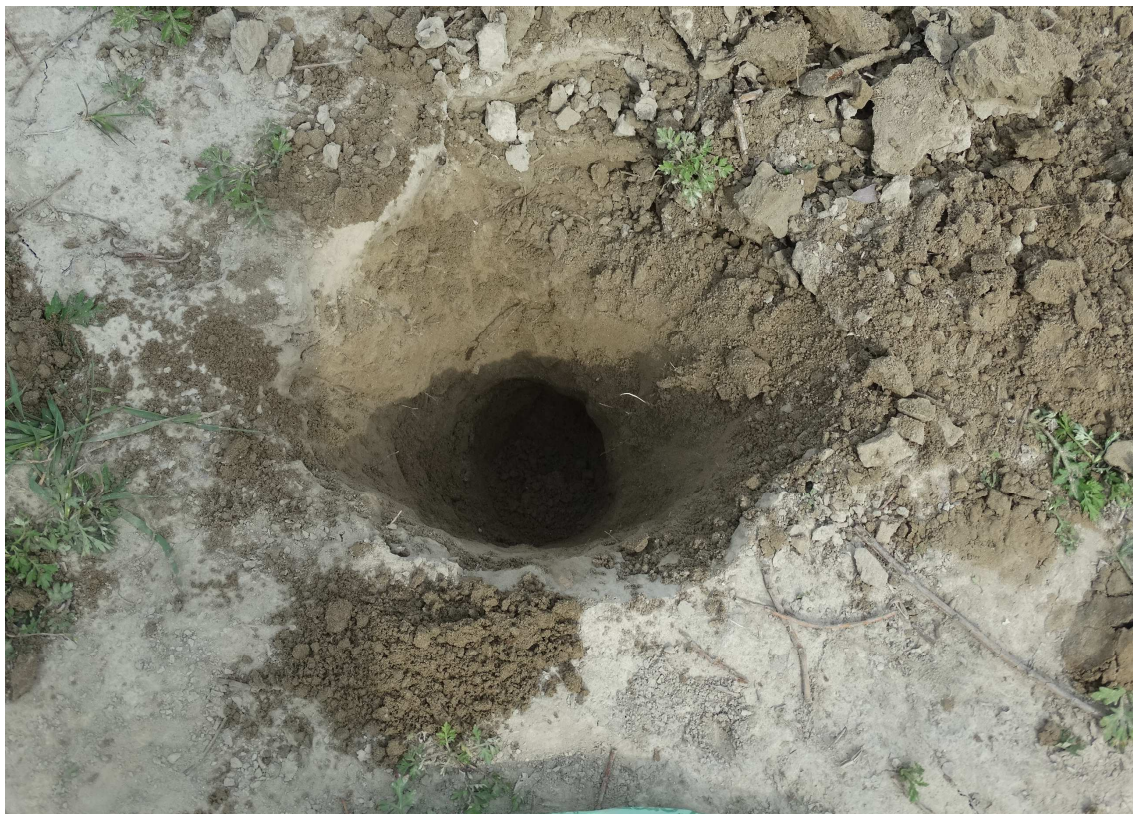
Figura 26: Documentazione fotografica del saggio manuale nella zona della golena, costituito da sabbie fini di colore marrone.
